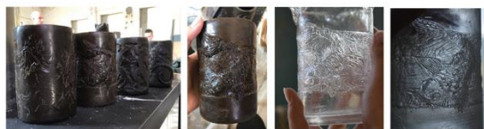
Рисунок 5 – Процесс создания стакана в технике «Утекающего воска»
