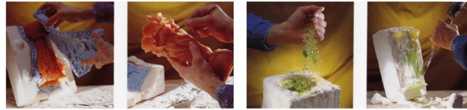
Рисунок 2 – Процесс создания изделия из восковой модели.
